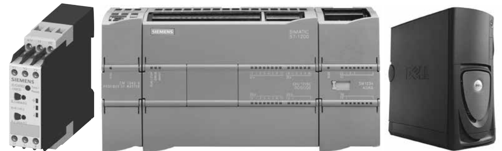
Sl. 1.20 Relej, PLC i računar
